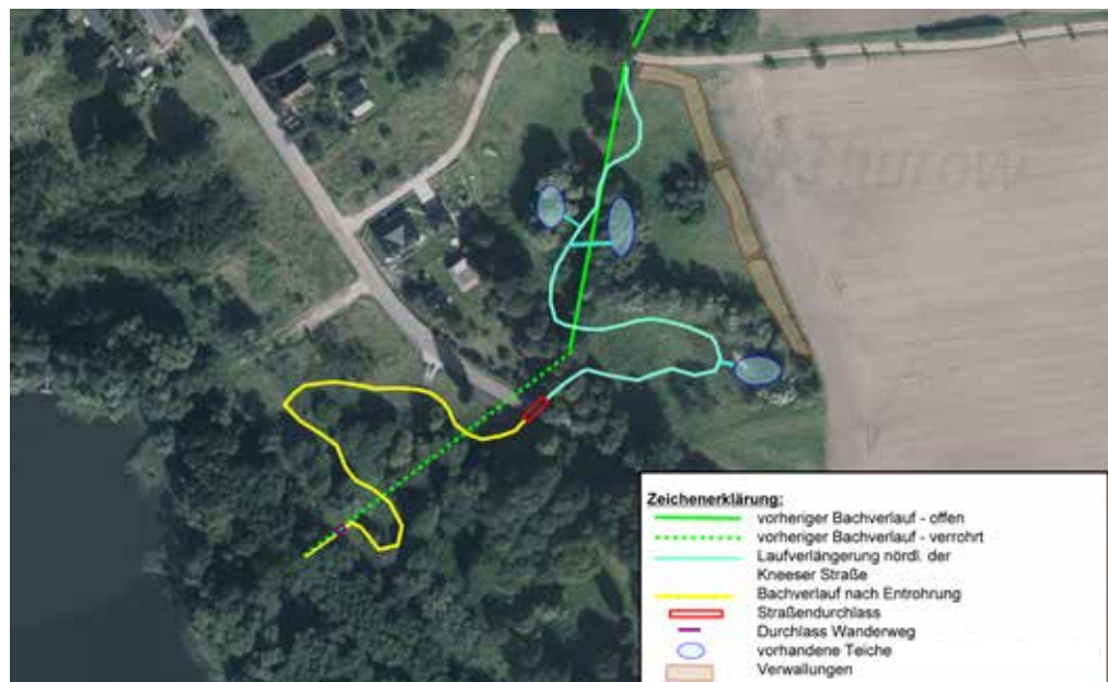
Entrohrung des Weitendorfer Baches (Planungsgemeinschaft bioplan GmbH und ROGA Ing. Büro GmbH)
